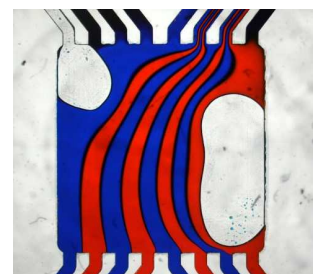
Laminar flow around «obstacles» (bubbles)
